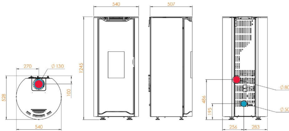
● Arrivée d'air ● Sortie des fumées
